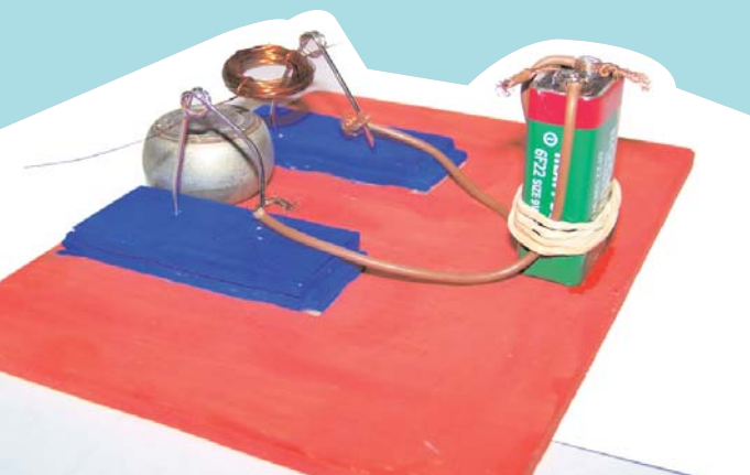
IMAGEN 4: MOTOR ELÉCTRICO CASERO
