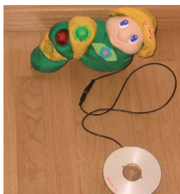
PULSADOR ELABORADO CON UNA CARCASA DE PEDAL / JUGUETE ADAPTADO CON EL PULSADOR.
