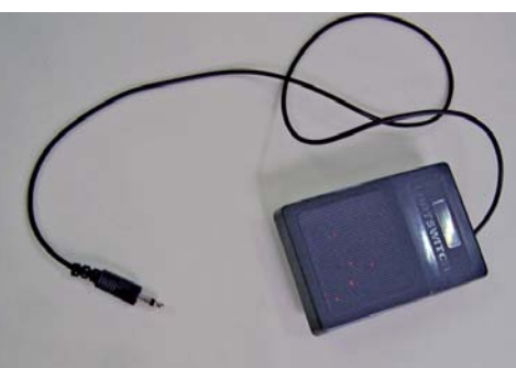
PULSADOR ELABORADO CON UNA CARCASA DE PEDAL / JUGUETE ADAPTADO CON EL PULSADOR.
