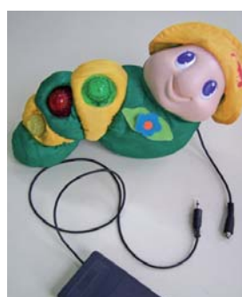
PULSADOR ELABORADO CON UNA CARCASA DE PEDAL / JUGUETE ADAPTADO CON EL PULSADOR.
